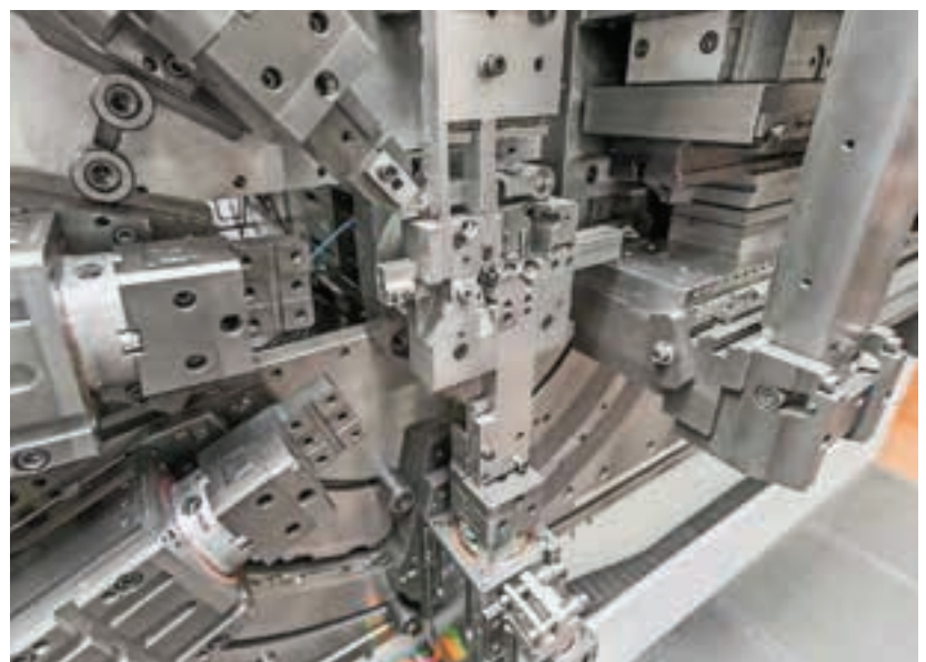
Arbeitsbereich der Bihler GRM-NC mit NC-Werkzeugmodulen.
