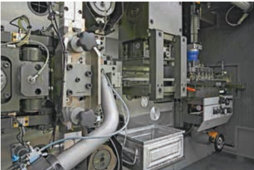
Arbeitsbereich der auf die hochproduktive Fertigung von Buchsen optimierten Bihler RM 40B.
