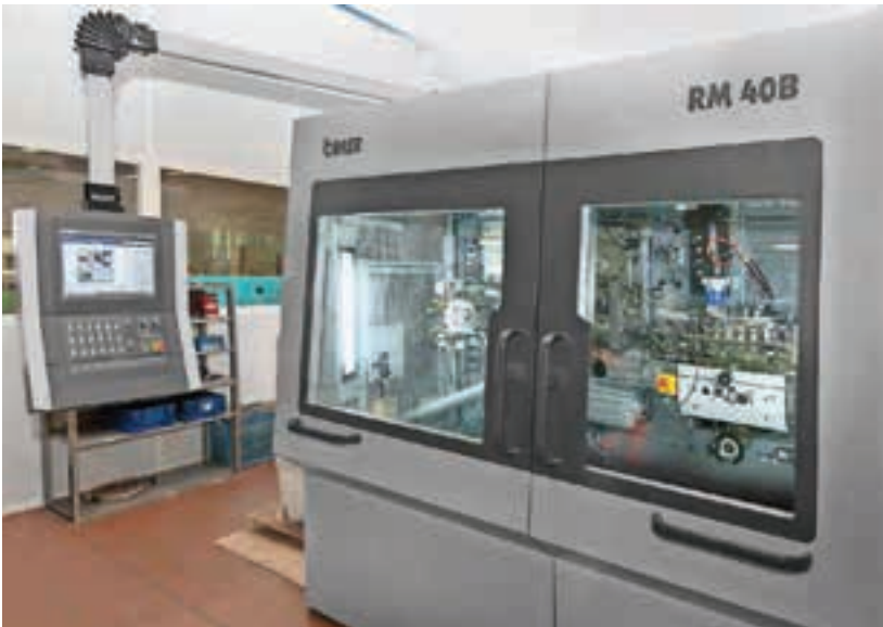
Auf der RM 40B fertigt Biegeform Dittmann zwei Typen von Bundbuchsen für die Automobilindustrie in Jahresmengen von 8 Millionen und 6 Millionen Stück.
