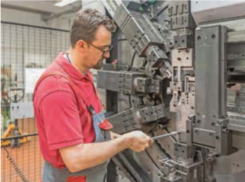
Das Setup der Maschine erfolgt mit einer motorischen Positionierung der Werkzeuge, die der Bediener nur noch „verriegelt“.
