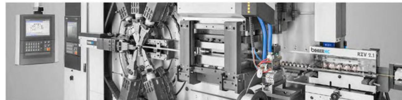
I componenti con contatti saldati per la tecnologia di commutazione industriale possono essere prodotti in modo efficiente con la tecnologia di tranciatura-piegatura - ad altissima velocità e con una qualità costantemente elevata. Questi componenti di contatto sono utilizzati in molti settori: dalla tecnologia dell'informazione a quella di controllo e regolazione, fino alla tecnologia a bassa, media e alta tensione.
