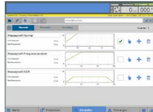
Online-Parameter-Schnellverstellung für Schweißprofil
