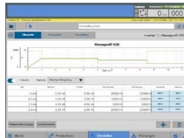
Schweißprofil mit 4 Abschnitten und unterschiedlichen Frequenzen
