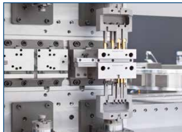
Einfaches Entfernen des kompletten Biegemoduls mittels aufsteckbarer Schnellwechsellvorrichtung
