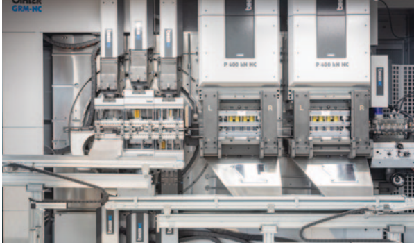
Fertigung der Busbars mit dem Leantool Linear und zwei Servopressen.
