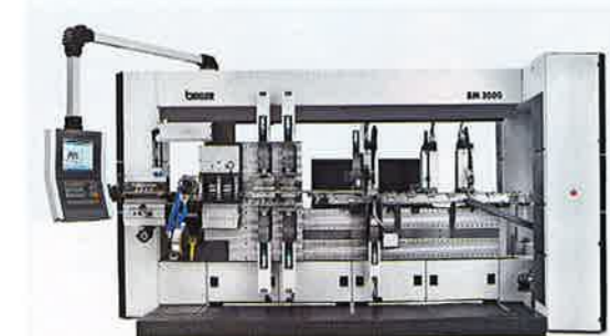
Servo-Produktions- und Montagesystem Bimeric BM 3000.
