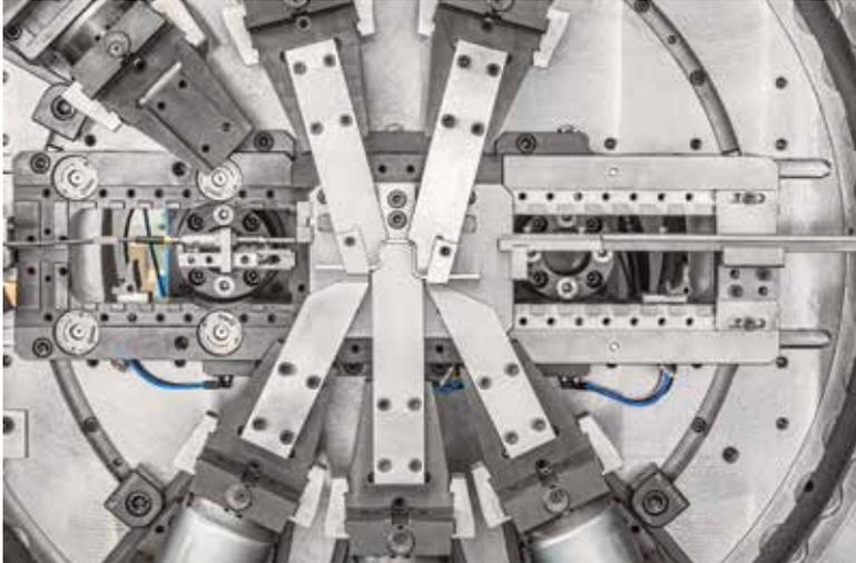
Die Radialfertigung der Busbars auf einer GRM-NC spart 50 Prozent an Material.
