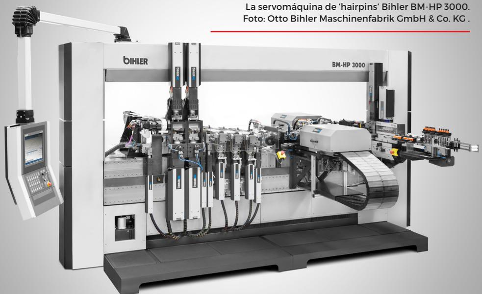
sistema. En lo que respecta a la geometría del cabezal y la longitud de los 'hairpins', el cambio de una variante a otra se realiza 'sobre la marcha', es decir, de forma totalmente automática y con una velocidad de ciclo de máquina invariable, únicamente a través del control central VariControl. Esto ahorra un tiempo valioso y garantiza una producción sin problemas.
