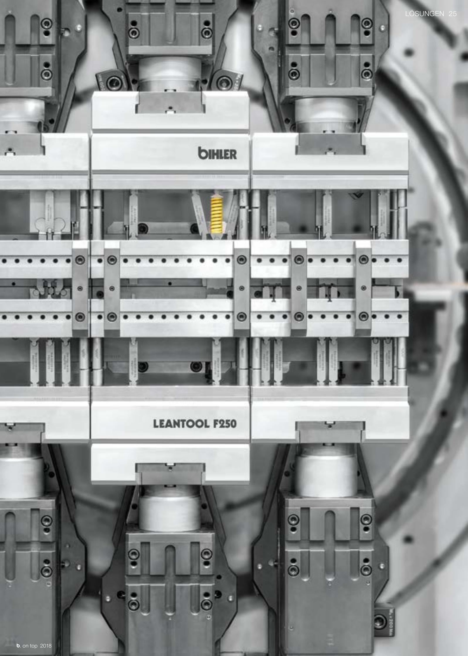
Die nach dem neuen Bihler LEANTOOL Folgeverbund-System gebauten Werkzeuge lassen sich dank spezieller Schnellwechselschnittstellen bei der GRM-NC besonders rasch wechseln.
