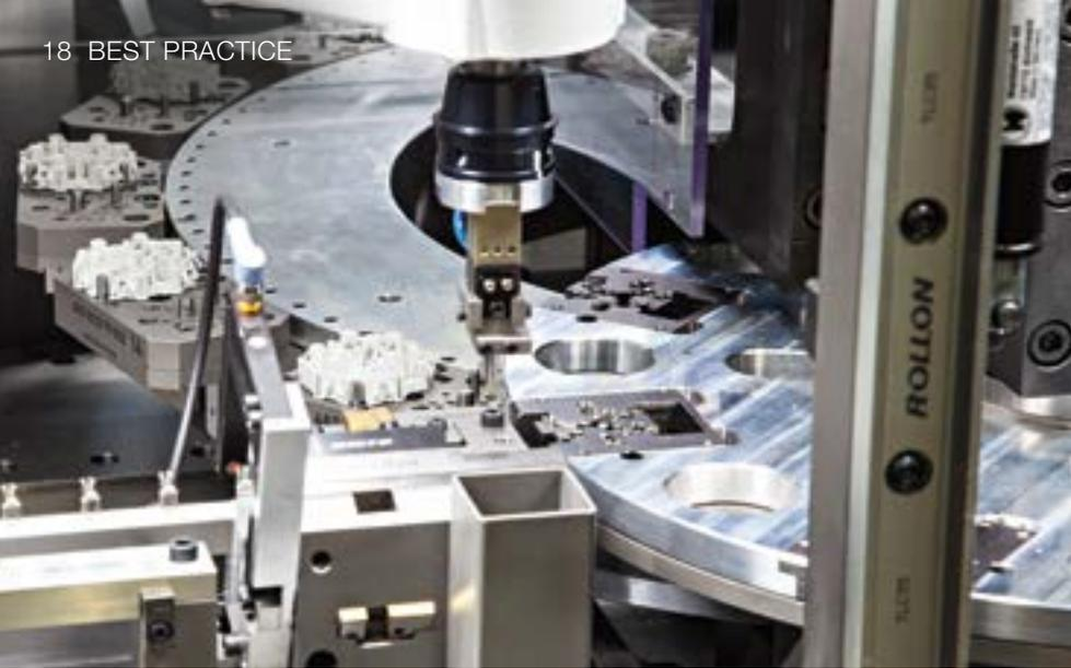
Die hochpräzise Inlinefertigung auf dem BIMERIC BM 3000 gewährleistet auch die erforderliche Genauigkeit beim Zusammenbau – mit nur 0,25 Millimetern Spielraum.
