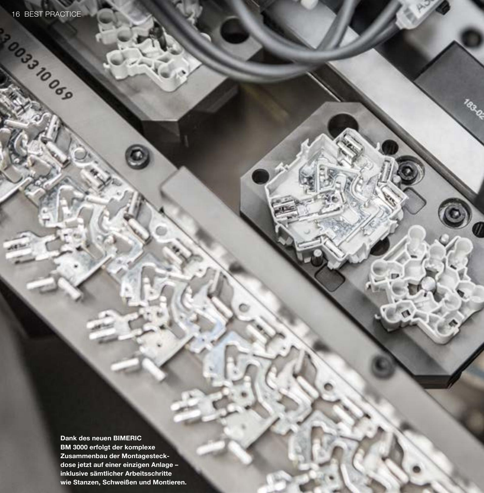
Dank des neuen BIMERIC BM 3000 erfolgt der komplexe Zusammenbau der Montagesteckdose jetzt auf einer einzigen Anlage – inklusive sämtlicher Arbeitsschritte wie Stanzen, Schweißen und Montieren.
