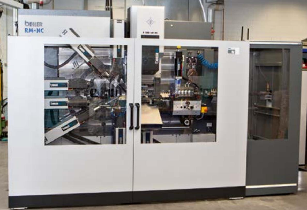
Das Herzstück der Anlage: die radial angeordneten, NC-gesteuerten Aggregate. Sie sorgen für höchste Fertigungsqualität bei gleichzeitig maximalen Hubraten.
