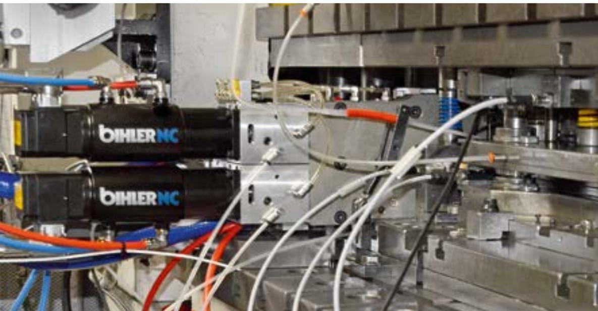
Das Bihler NC-Kontaktschweißgerät D1K mit zwei Servoantrieben und der Schweißsteuerung B 5000-NC ermöglicht das besonders präzise und hochwertige Kontaktschweißen unabhängig vom Takt der Gesamtanlage.
