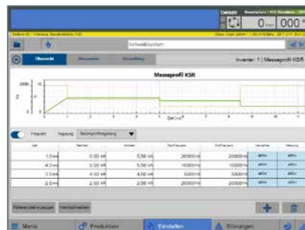
Profilo di saldatura con 4 sezioni e frequenze diverse
