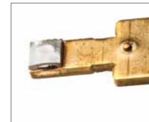
Soldadura por resistencia
