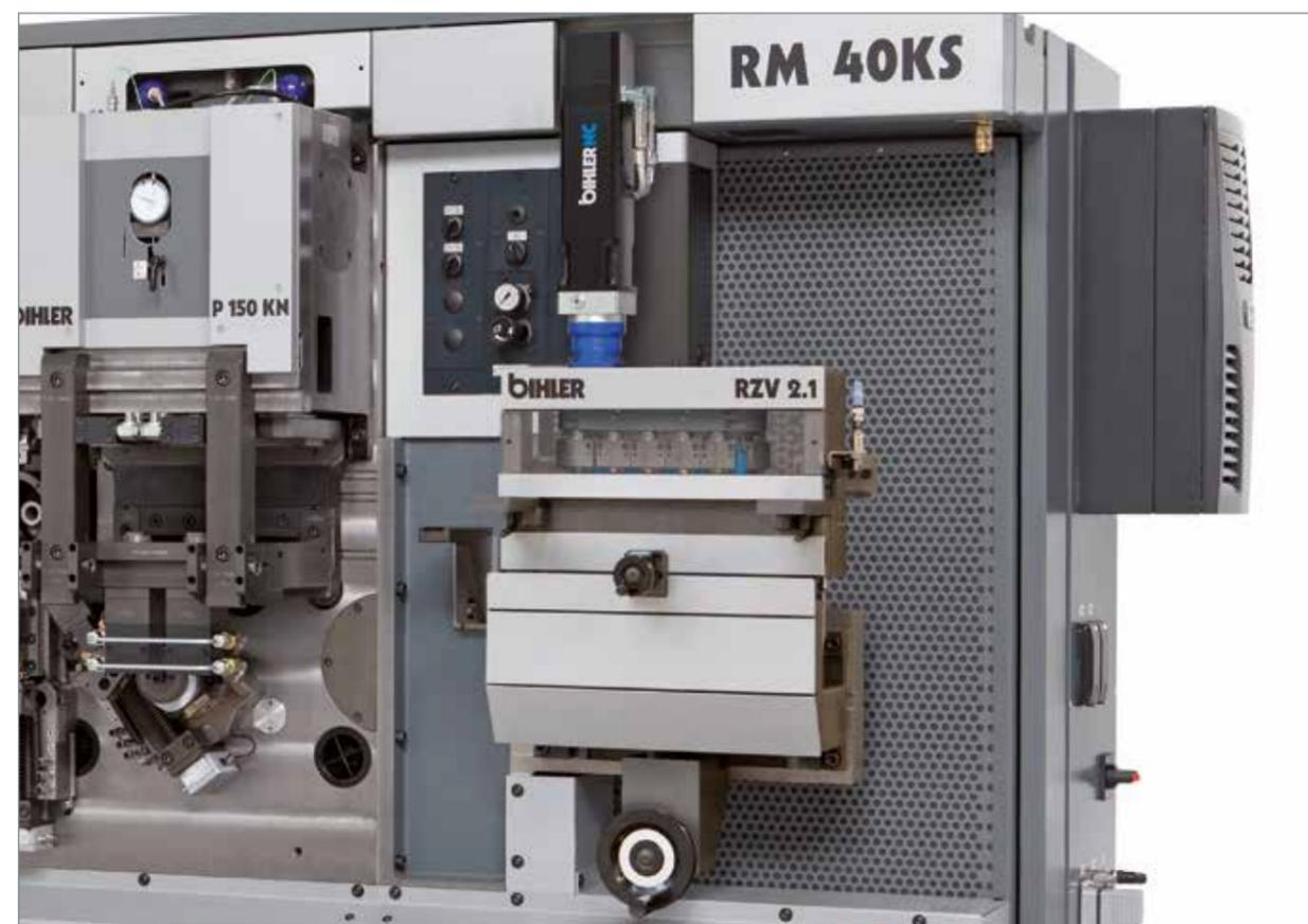
RZV 2.1 con dispositivo di regolazione a due assi e protezione contro le scariche
