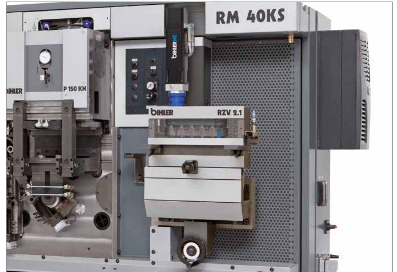
RZV 2.1 avec dispositif pour réglage horizontale et verticale et protection contre les contacts
