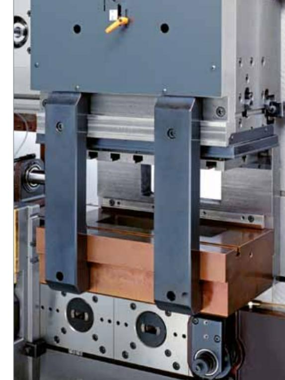
L'amenée de matériau depuis les quatre côtés et la possibilité d'adaptation de la presse aux deux faces sont partie intégrante du concept de la machine. La table universelle solide présente une ouverture proposée en série pour les déchets de découpage et suffisamment de place pour l'installation de blocs à colonnes standardisés jusqu'à 480 mm de long.
