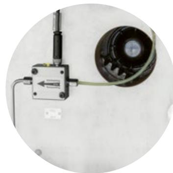
Capteur des points de lubrification pour le contrôle de lubrification de la grande roue
