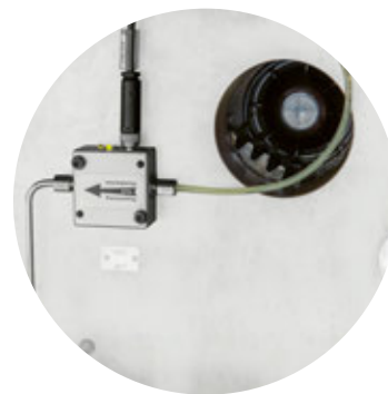
Sensor de puntos de lubricación para vigilar la lubricación del engrane grande
