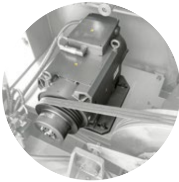
Neuer frequenz geregelter Antrieb - stufenlos regelbar
