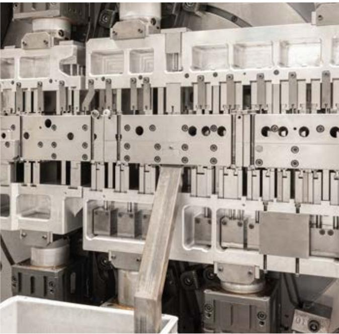
Los enchufes para cargar vehículos eléctricos se fabrican en una nueva GRM-NC de Bihler. La herramienta lineal correspondiente fue diseñada directamente en M.S.Ambrogio.
