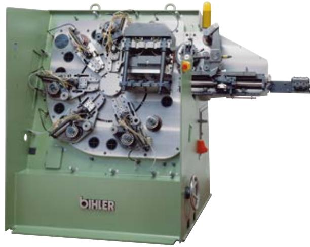
El sistema modular Bihler con soldadura y montaje se basa en las punzonadoras y plegadoras automáticas RM 35 y GRM 50.
