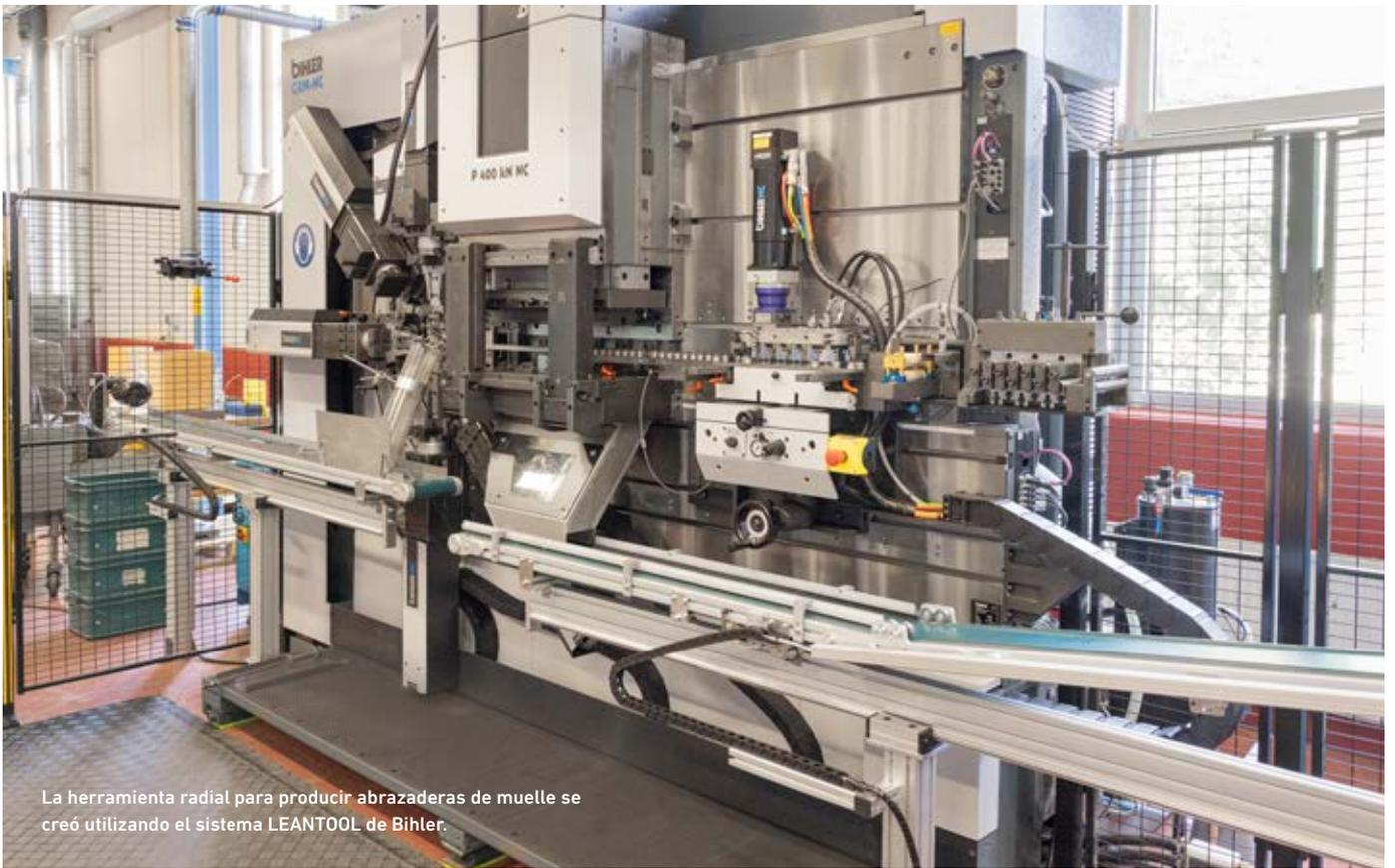
La herramienta radial para producir abrazaderas de muelle se creó utilizando el sistema LEANTOOL de Bihler.
