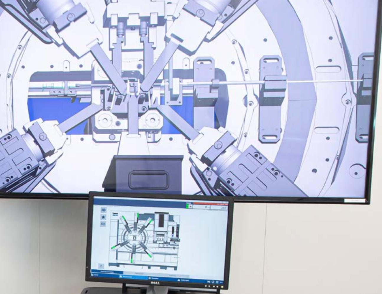
La formación se lleva a cabo en el gemelo digital de la instalación. Todas las funciones se pueden simular a través del panel de control real de VC 1.
