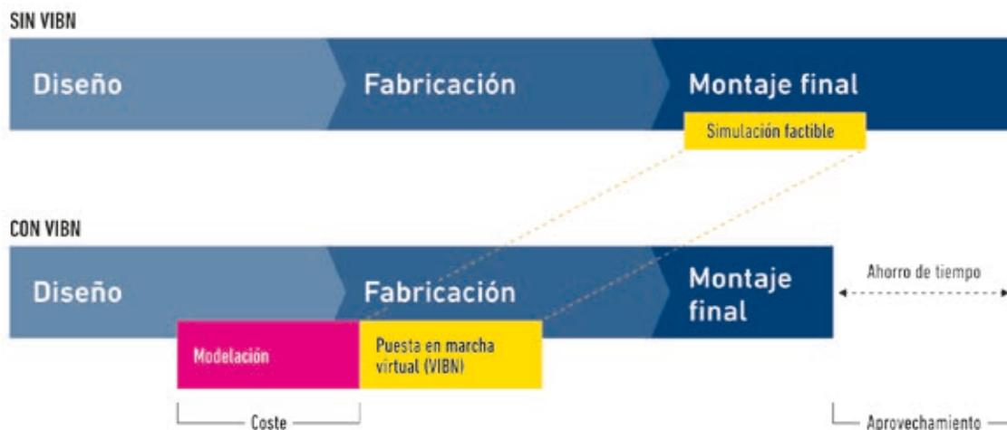
El esfuerzo de la puesta en marcha virtual (VIBN) es mayor al principio, pero acorta los tiempos de preparación y puesta en marcha posteriores y mejora la calidad de la instalación.
