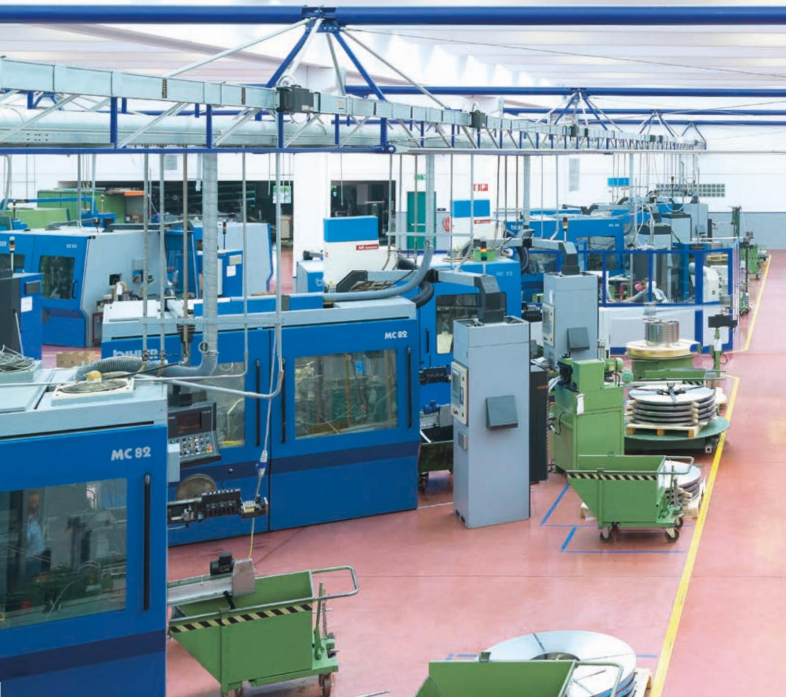
Für die zunehmende Nachfrage nach kleineren Serien setzt die norditalienische Mi Me S.p.A. auf neueste Technik – mit zwei Bihler Stanzbiegeautomaten RM-NC und GRM-NC sowie dem Bihler LEANTOOL-System für die Werkzeugherstellung. Wichtigste Entscheidungsfaktoren waren die Reduzierung der Kosten und die Steigerung der Wirtschaftlichkeit.
