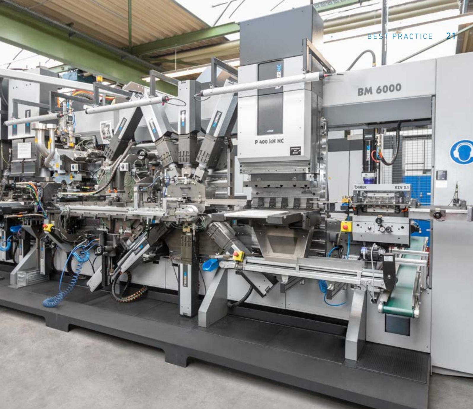
gungsleistung mit bis zu 60 Hübten pro Minute. Gleichzeitig ist die Maschine auf optimale Materialausnutzung ausgelegt und spart gegenüber dem Tiefziehen rund 30 Prozent Material ein. Das ist bei geplanten 28 Millionen Teilen pro Jahr ein erheblicher Effizienzvorteil, nicht nur wirtschaftlich angesichts stark gestiegener Materialkosten. Vielmehr können durch den verringerten Materialeinsatz auch jedes Jahr tausend Tonnen CO<sub>2</sub> eingespart werden.“
