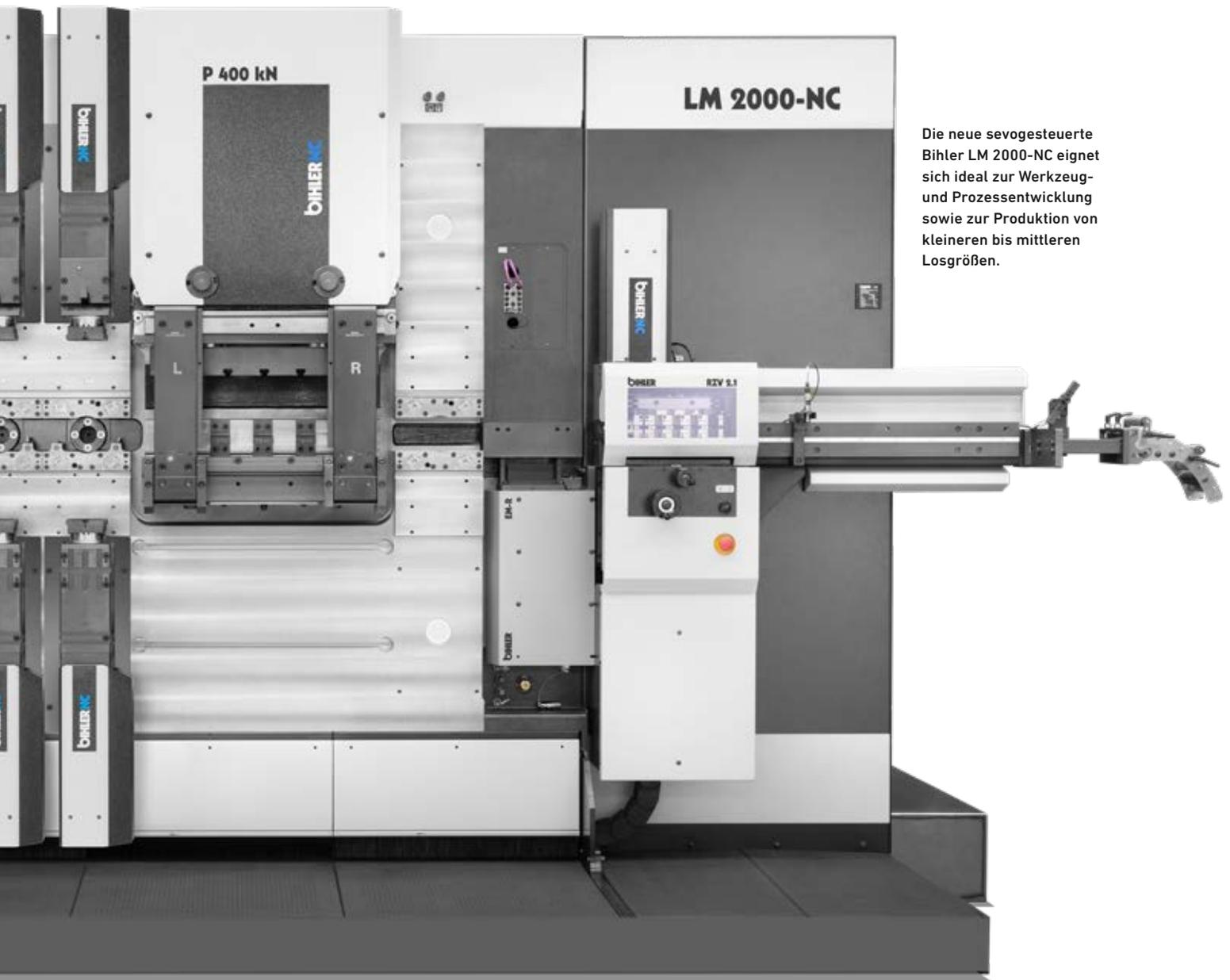
Die neue sevogesteuerte Bihler LM 2000-NC eignet sich ideal zur Werkzeug- und Prozessentwicklung sowie zur Produktion von kleineren bis mittleren Losgrößen.
