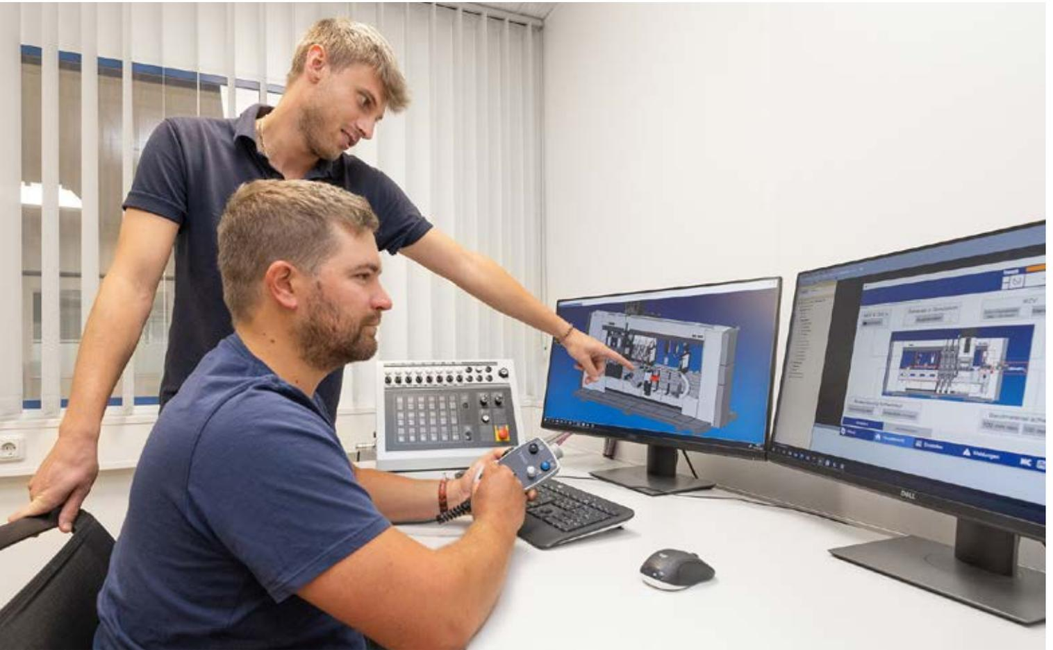
Die virtuelle Inbetriebnahme erfolgt an speziell konfigurierten Simulationsplätzen am Bihler-Standort in Halblech. Über die VC 1-Steuerung lassen sich insbesondere die Achsbewegungen der NC-Aggregate programmieren und am virtuellen Modell nachverfolgen.
