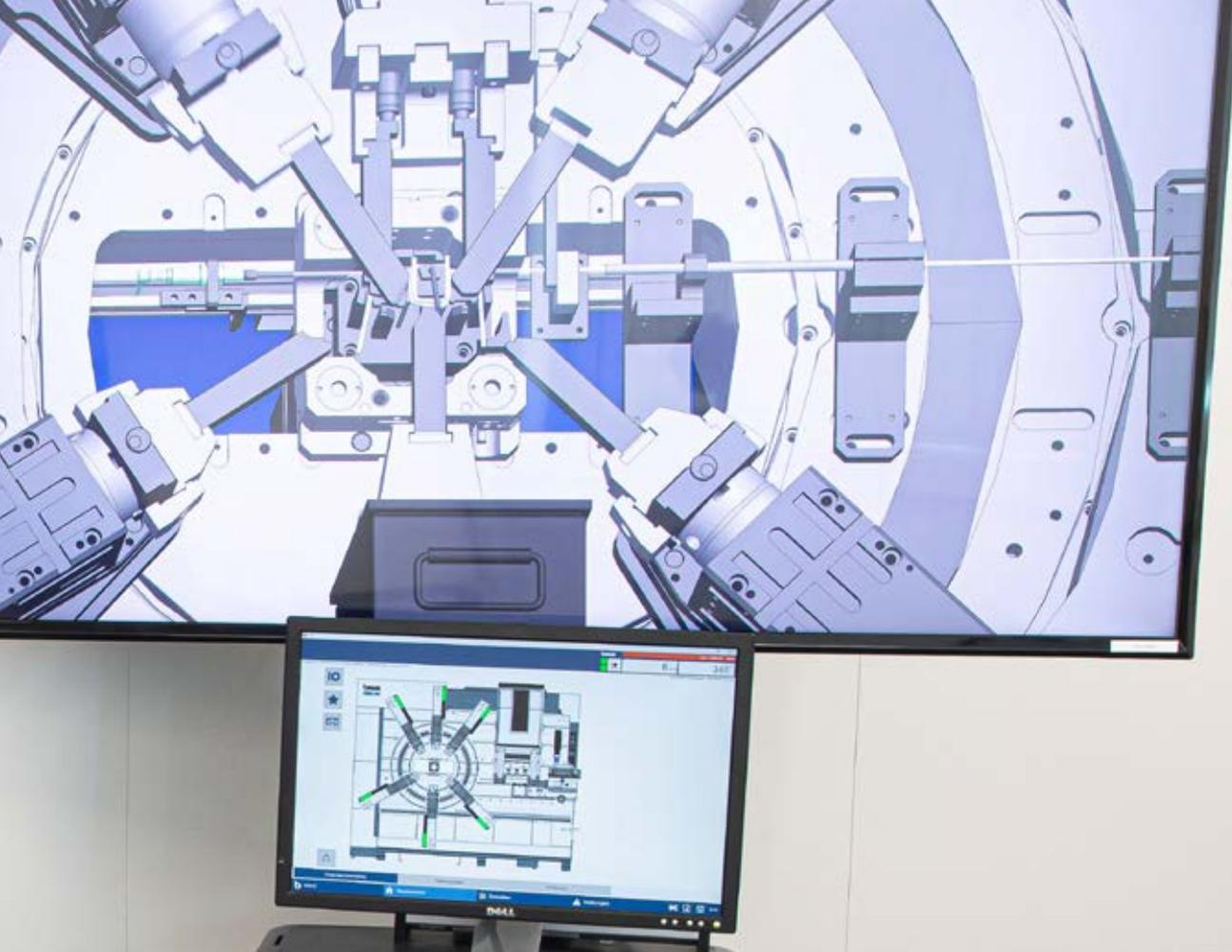
Durchgeführt wird die Schulung am digitalen Zwilling der Anlage. Über das reelle VC 1-Bedienpult lassen sich alle Funktionen simulieren.
