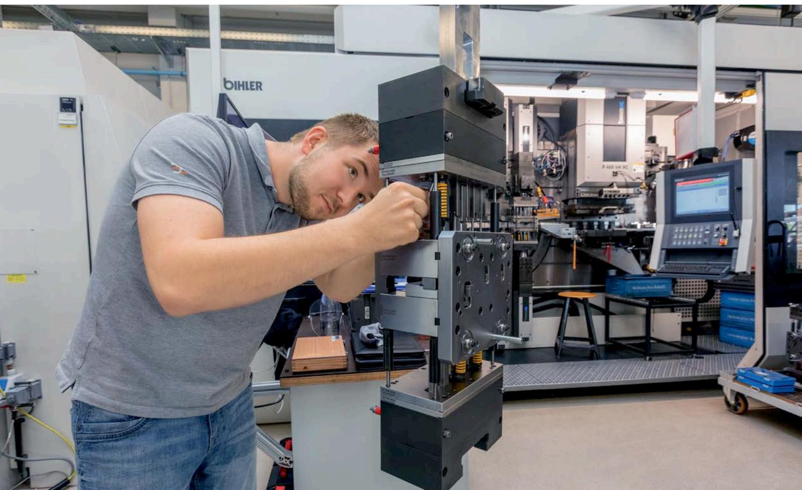
Il sistema di serraggio rapido del sistema Bihler LEANTOOL garantisce tempi di allestimento brevi con un posizionamento ottimale dell'utensile.
