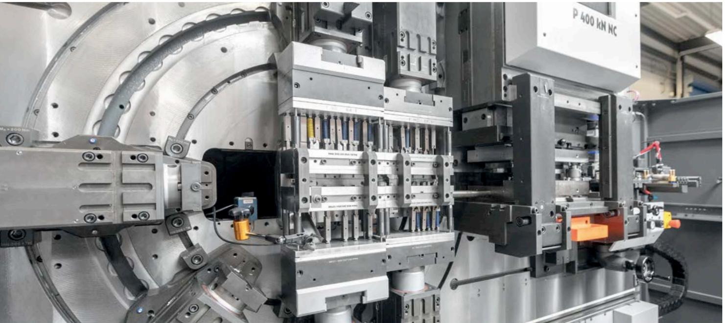
Ya se usan seis herramientas progresivas y radiales con hasta 250 carreras por minuto, las cuales están fabricadas con el sistema LEANTOOL de Bihler.
