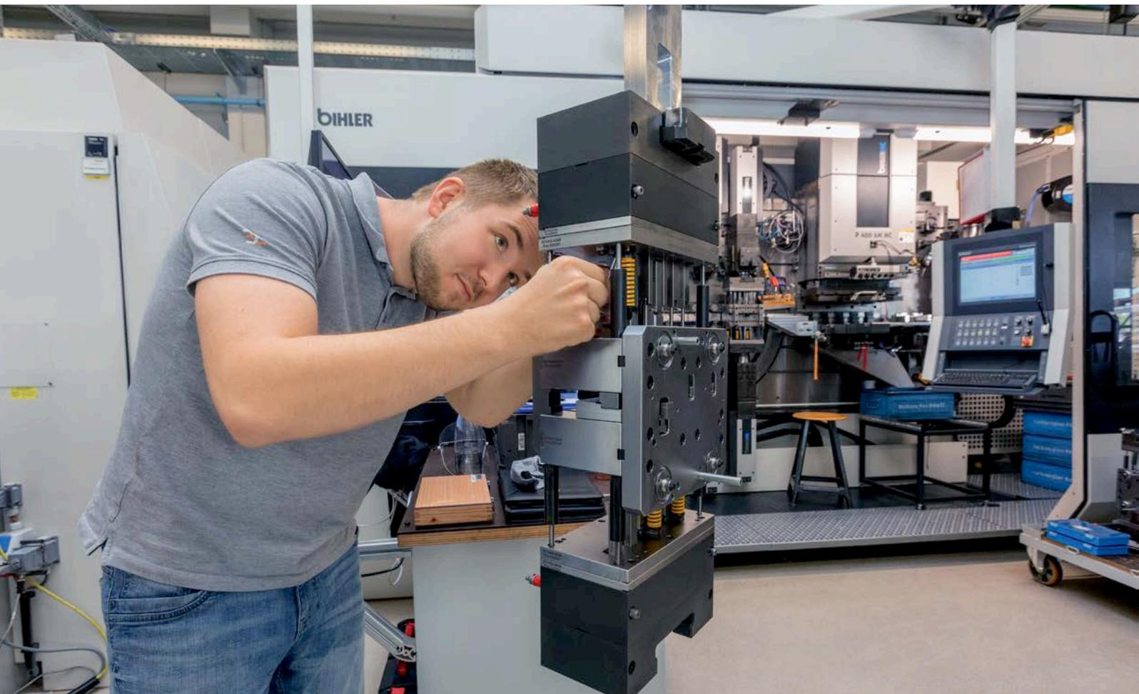
El sistema de sujeción rápida del sistema LEANTOOL de Bihler permite trabajar con unos tiempos de preparación cortos y posicionando las herramientas óptimamente.
