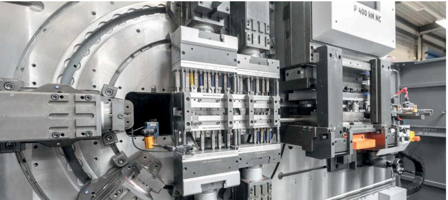
Sechs nach dem Bihler LEANTOOL-System hergestellte Folgeverbund- und Radialwerkzeuge sind mit bis zu 250 Hübem pro Minute bereits im Einsatz.
