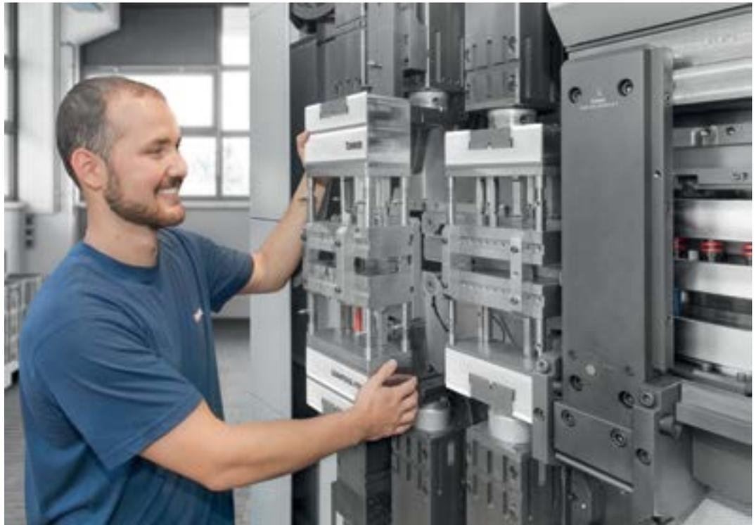
Dank der standardisierten Schnittstellen des LEANTOOL F250-Systems lassen sich alle Einheiten besonders schnell und einfach rüsten und wechseln.
