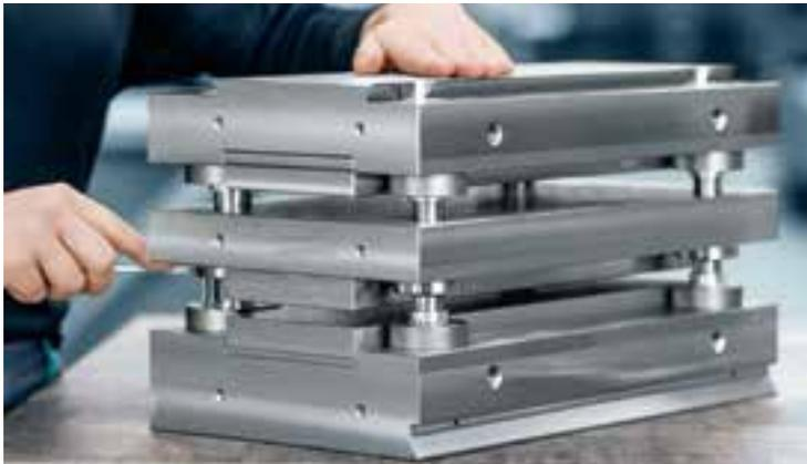
Die neuen Stanzbiegegestelle mit gefederter Führungsplatte führen die Standardisierung im Stanzbiegebereich weiter und entlasten die Anwender von der zeit- und kostenintensiven Einzelfertigung.
