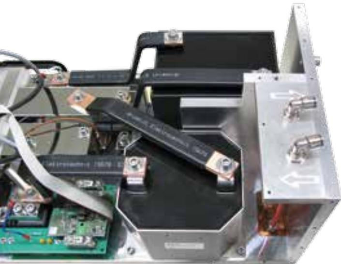
Die aktive Versorgungsschaltung der B 20K schützt die Schweißanlage zuverlässig vor Netzschwankungen etwa durch andere hohe Verbraucher. Die interne Versorgungsspannung wird dazu zunächst angehoben und dann gezielt abgesenkt.
