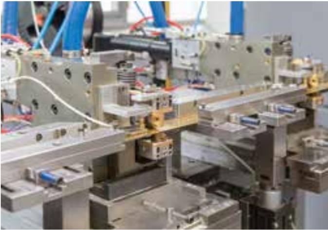
Die Profile und Startzeiten aller Aggregate sind so programmiert, dass sie teilweise simultan ablaufen. Dadurch können besonders hohe Fertigungsgeschwindigkeiten erzielt werden.
