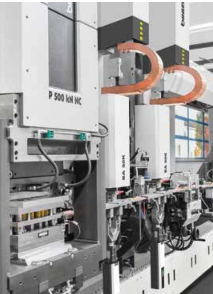
Der neue NC-Linearaktor ermöglicht es, Band und Kontaktmaterial nun in einer linearen, exakt steuerbaren Bewegung miteinander zu verschweißen. Der Schweißstrom hat außerdem keinerlei Auswirkungen mehr auf die Schweißkraft.
