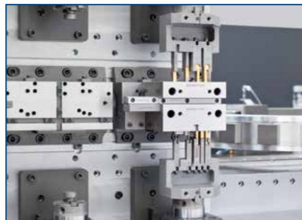
Suppression aisée du module de cambrage grâce à un dispositif de changement rapide à enficher et verrouiller
