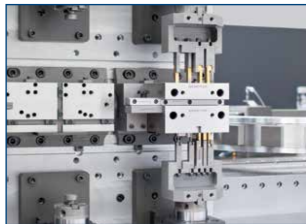
Extracción sencilla de todo el módulo de doblado utilizando el dispositivo-clip de cambio rápido.
