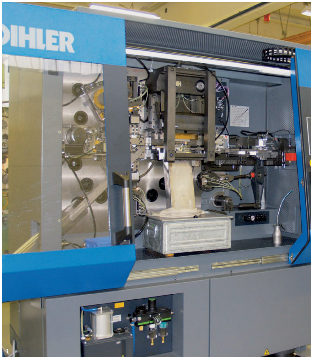
1 Der neueste Bihler-Stanz-Umformautomat RM 40K in der Schnöring-Fertigung erlaubt auch die problemlose Übernahme älterer Werkzeuge bei massiv höherer Produktivität.
